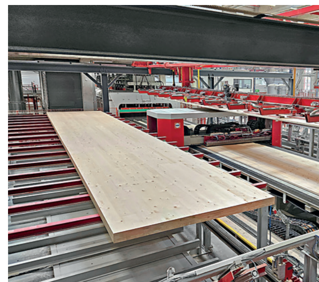
Mit 120.000 m 3 Jahreskapazität CLT ist der Stora Enso-Standort Zdirec einer der größten weltweit
