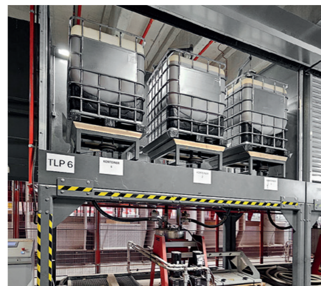
Der Klebstoff wird in Mehrweg-IBC mit trichterförmigem Auslauf geliefert. Das schont die Umwelt ebenso wie den Geldbeutel
