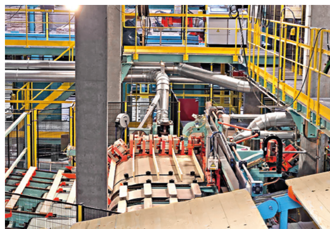
Beim Zinkenstoß setzt Mayr-Melnhof Holz ebenso auf den PUR-Klebstoff von Türmerleim wie bei der Flächenverklebung
