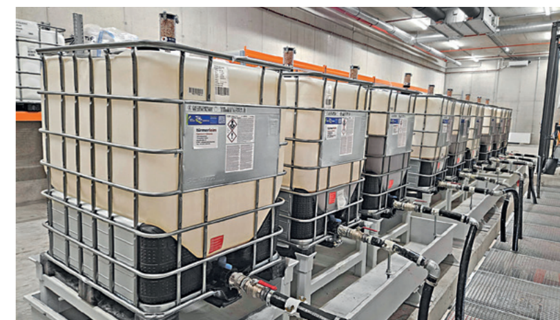
Bien rangés, les conteneurs GRV réutilisables approvisionnent l'usine CLT de Mayr-Melnhof Holz à Leoben avec l'Elastan TLP de Türmerleim
